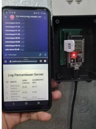
Gambar 5 : Alat mendeteksi suhu dan mengirim notifikasi melalui bot telegram
