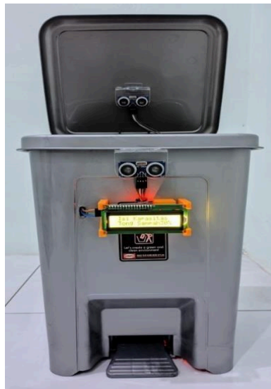
Gambar 17 Produk Prototype Ketika Dalam Keadaan Terbuka
