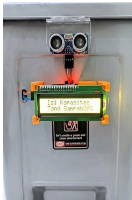
Gambar 19 Tampilan LCD Saat Isi 20%
