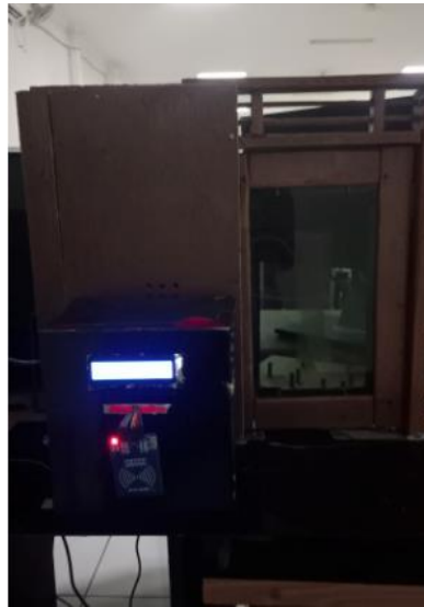
Gambar 4 Pintu Otomatis Menggunakan RFID
