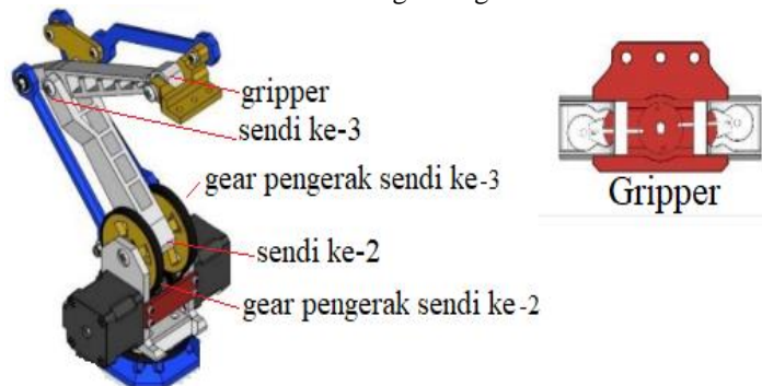
Gambar 4 : Desain Rancangan Bagian Atas Robot Arm
