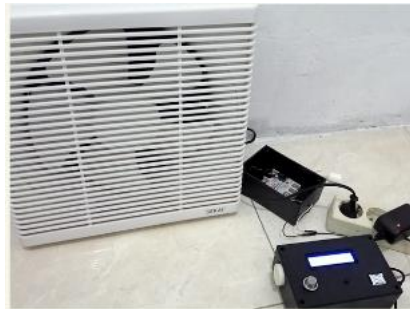
Gambar 4. Prototipe alat deteksi kebocoran gas
