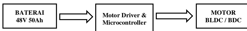
Gambar.1 Blok diagram sistem penggerak motor
