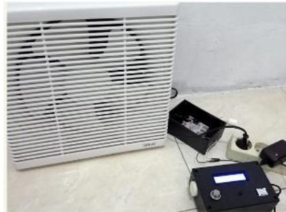
Gambar 4. Prototipe alat deteksi kebocoran gas
