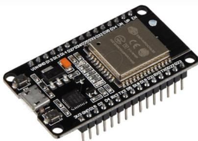
Gambar 1. Mikrokontroler ESP32
